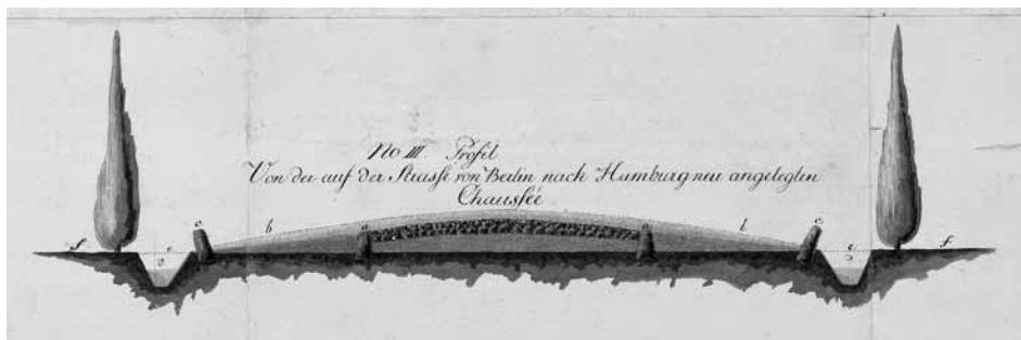
Preußischer Straßenbau: Entwurf des Unterbaus der Chaussee Berlin-Hamburg, 1802; Stich von L. L. Koppin, GStPK Berlin
